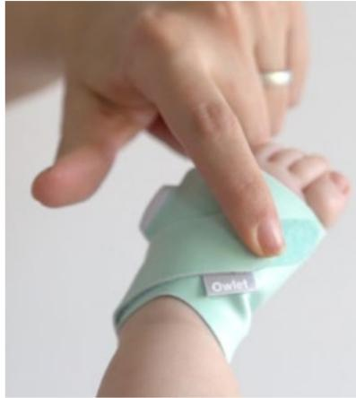
Bei richtiger Platzierung sollte der Klettverschluss oben auf dem Fuß zum großen Zeh hin zeigen, und der Sensor sollte sich an der Außenseite
